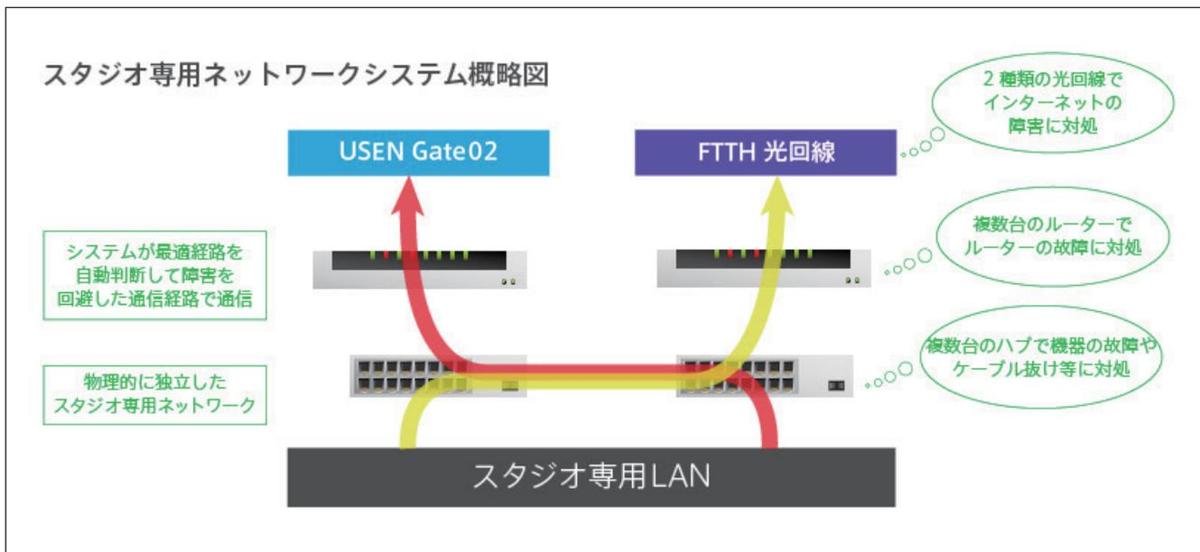
インターネットライブ配信を実施したいが、ネットワークトラブルが怖いとお考えのお客さまは多いかと思います。そんなお客さまの悩みを受け、アークベルの配信専用ネットワークでは、複数のネットワーク機器を用いたネットワークの冗長化と、インターネットプロバイダの多重化を行い、簡単には配信が停止しないシステムを構築致しました。ネットワーク機器だけでなく、インターネットプロバイダも多重化しているため、プロバイダの広域障害にも対応し、より安定した環境下での配信を実現できます。また、メイン回線に1社専有型のビジネス向け専用線を採用しているため、近年大きな問題になっている光通信の輻輳（通信が集中してインターネットが繋がらなくなることも起きにくいシステムとなっております。
